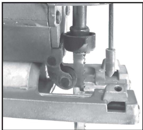
Pozor: Pila se během používání bude vlivem tření zahřívávat. Mějte toto zahřívání přístroje na paměti při výměně pilového plátku. Pokud je to nutné, používejte ochranné rukavice.
