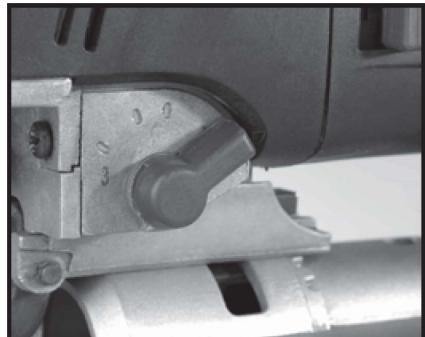
Pozor: Z dôvodu výskytu zvislého pohybu dôjde k otrepu rezaného materiálu viac a častejšie v prípade nastavenia predkmitu. Povrchová úprava dreva je obzvlášť náchylná na otrepky kvôli svojej štruktúre pri práci s predkmitom.
