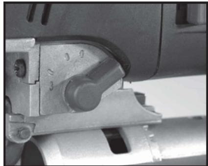
Pozor: Z důvodu výskytu svislého pohybu dojde k otřepu řezaného materiálu více a častěji v případě nastavení předkmitu. Povrchová úprava dřeva je obzvláště náchylná na otřepy kvůli své struktuře při práci s předkmitem.
